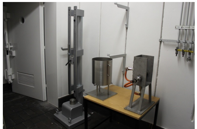
Fallhammer, Dutch Pressure Vessel und Stahlhülsen-Anlage für den Köhnen-Test
