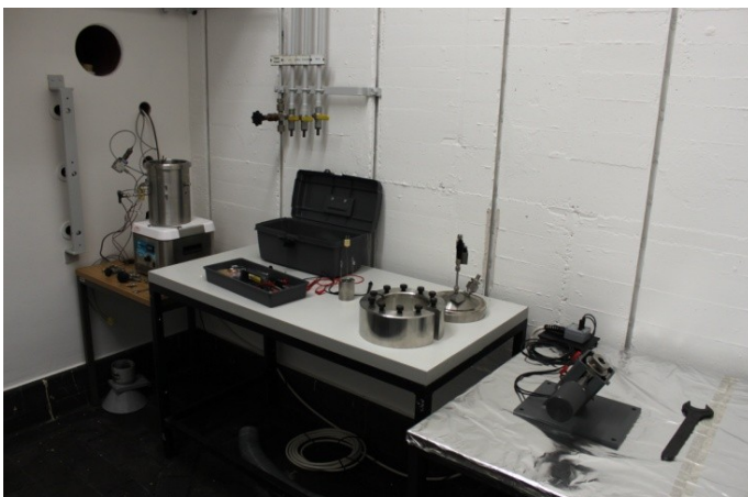
Das VSP (Vent Sizing Package) und die Apparatur für den A21-Test
