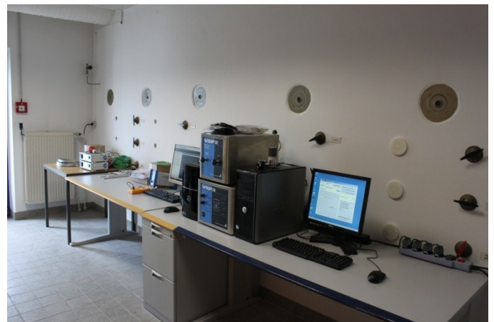
Die „Messwarte“ zum Steuern und Überwachen der Apparaturen aus sicherer Entfernung
